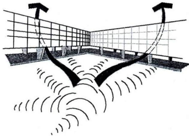
شکل ۲-۲۱-۵- تخلیه موج انفجار از پیلوت باز
